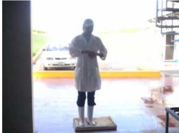
Fig. 13. Sistema de pediluvio para desinfección de calzado
